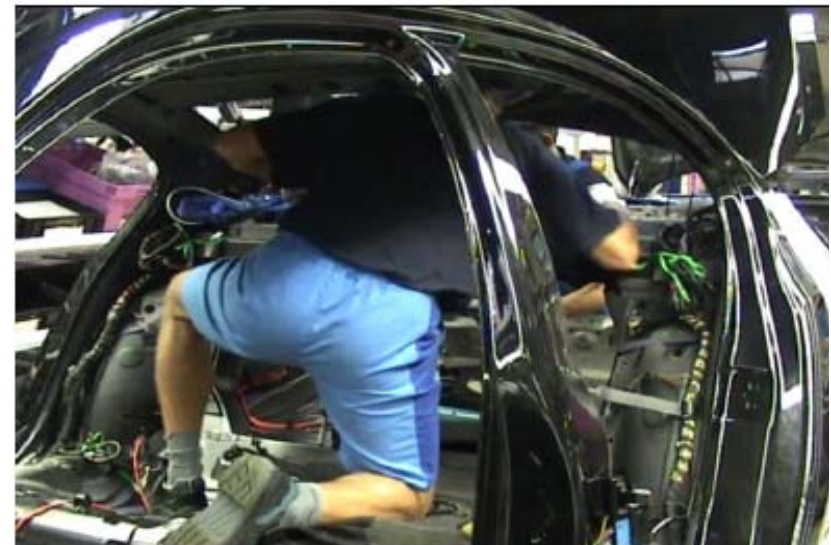
Verlegen des Kabelbaums auf der Hutablage
